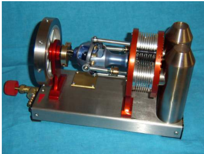
FIGURE 16.8 – Moteur gamma double à embiellage oscillant
