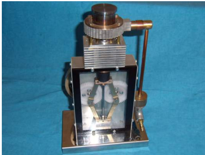
FIGURE 16.5 – Moteur bêta - Embiellage rhomboïdal
