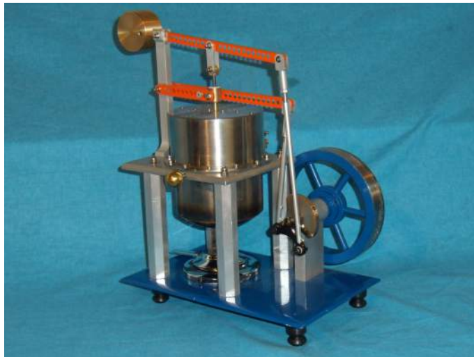
FIGURE 16.6 – Moteur gamma - Piston membrane avec réserve d'eau supérieure
