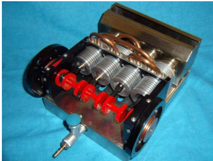
FIGURE 16.11 – Moteur gamma 4 cylindres double-effet
