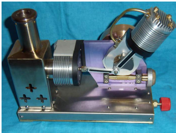
FIGURE 16.9 – Moteur gamma. Déphasage réglable en fonctionnement de 60 à 120 degré
